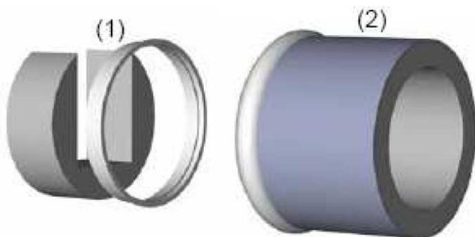
**BOALMA** : Mousse acoustique + pièce de maintien. La mousse de mélamine s'emboîte derrière la bouche sanitaire avec la pièce de maintien plastique (image 1)
