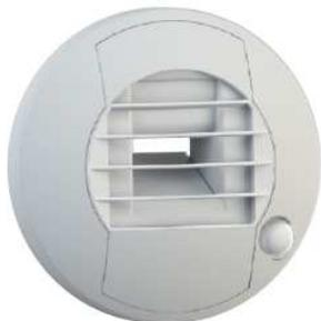
Dans le cas des WC et salle de bains communs, un débit modulé suivant l'humidité relative ambiante de la pièce et un débit complémentaire temporisé (30 minutes) dont l'ouverture est commandée électriquement.
